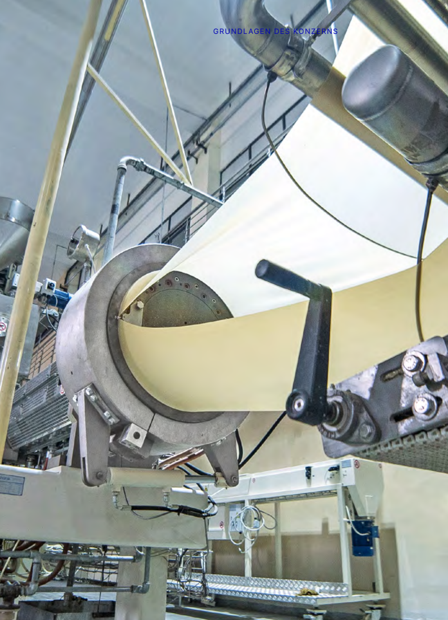
Links: Gelatinisiertes Sheet, dass aus dem Extruder tritt. Unten: Zutatenmischung des Teigs
