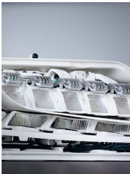
In der Musterbaufertigung entsteht der Prototyp eines Scheinwerfers.
