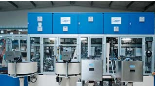
Montageanlage für Abgasrohrverbinder im Werk Gerbershausen
