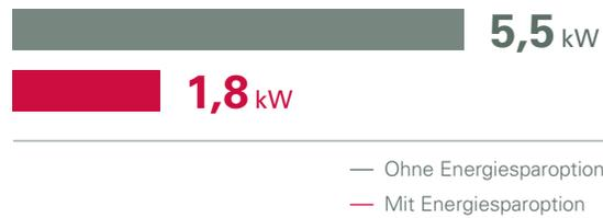
Die Energiesparoption der Wälzkolbenpumpen AD 30 KL und AD 70 KL reduziert den Stromverbrauch im Stand-by-Betrieb um etwa zwei Drittel.
