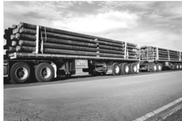
18 Tonnen Achslast: York-Schwerlastachsen im Einsatz
