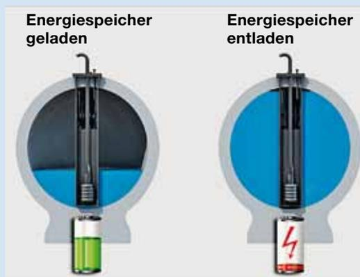
den. Das Energiepotenzial hängt dabei von der Wassertiefe und der Größe der Hohlkugel ab. Ein Beispiel: Eine Kugel von zirka 30 Metern Durchmesser und einem Fassungsvermögen von 12 000 Kubikmetern in 700 Meter tiefem Wasser ermöglicht die Speicherung von 20 Megawattstunden Energie. Untersuchungen und Berechnungen zum Speicherinhalt gehen von einem Lade-Entlade-Wirkungsgrad von 85 Prozent aus.
